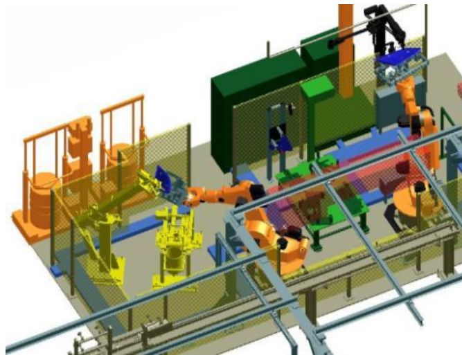
Slika 192: Robotska celica narejena s simulacijskim programom ROBCAD
