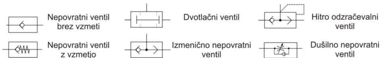
Slika 76: Simboli zapornih ventilov
